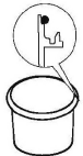
Korrekt placering af o-ring. Korrekt placering av o-ring. Correct placement of o-ring.
